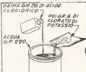
SOLUZIONE PER INCISIONE PROFONDA SULL'ACCIAIO
