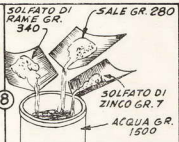
SOLUZIONE PER INCISIONE POCO PROFONDA SU FERRO ED ACCIAIO
